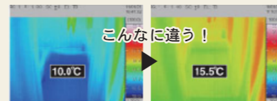
一般の断熱工法 アクアフォーム 暖房停止後 約30分の浴室の表面温度(外気温2.8°C)
