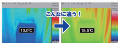
一般の断熱工法 暖房停止後 約30分の浴室の表面温度 (外気温2.8°C)
