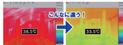
一般の断熱工法 冷房を使用しない部屋の小屋裏温度を測定 (8月末)
